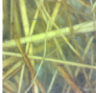
Gambar 6 Struktur Mikro Komposit 10% Kelapa : 20% Fiberglass
