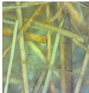
Gambar 7 Struktur Mikro Komposit 15% Kelapa : 15% Fiberglass
