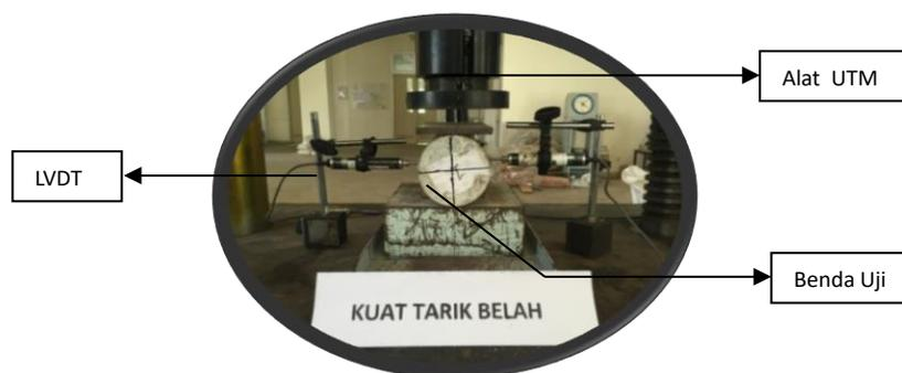
**Gambar 5.** Pengujian Kuat Tarik Belah Beton Pasir Laut
