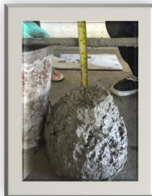
**Gambar 2.** Pengujian *Slump Test* Beton pasir laut
