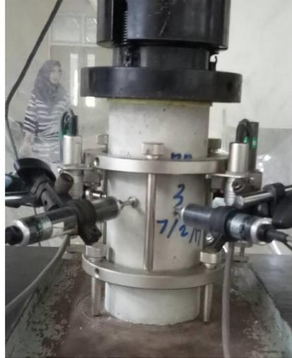
**Gambar 4.** Pengujian Kuat Tekan Beton Pasir Laut
