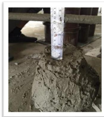
**Gambar 1.** Pengujian *Slump Test* Beton pasir sungai
