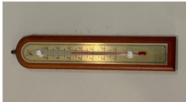
**Gambar 5. Alat Pengukur Suhu Ruangan**
